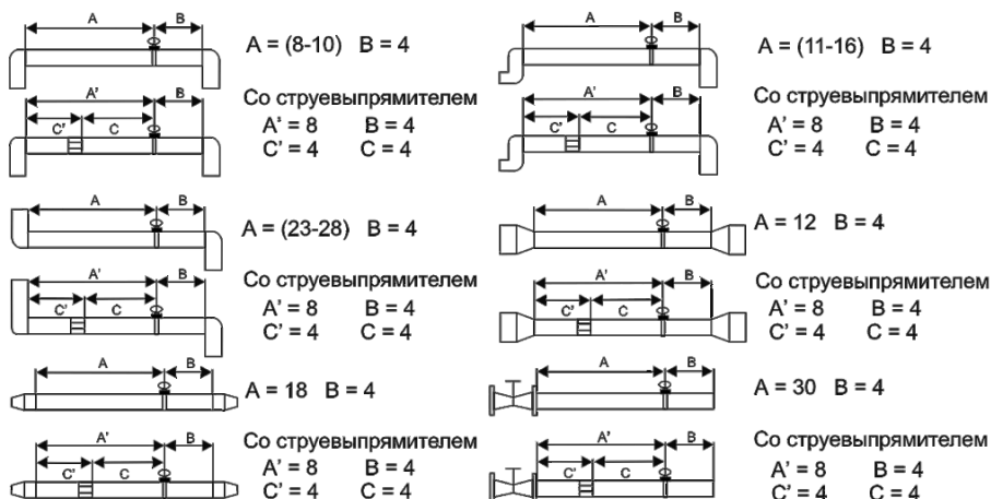
Рис. В.3 Требование к прямым участкам при монтаже ОНТ
